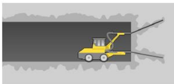
Injektering: Cementbruk pumpas in i borrhål och bergsprickor. När den stelnat bildas en tätning runt den blivande tunneln.
