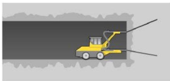
Borrhning för injektering: 20-25 meter långa hål borrar runt den blivande tunneln.
