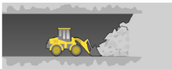
4. Löst berg knackas och bryts från berget. Vid behov förstärks berget med sprutbetong och bultar. Massorna efter det sprängda berget schaktas undan och transporteras ut ur tunneln.
