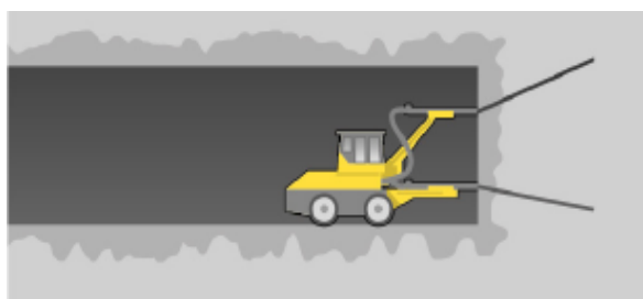
1. Borrhning för injektering: 20-25 meter långa hål borrar runt den blivande tunneln.
