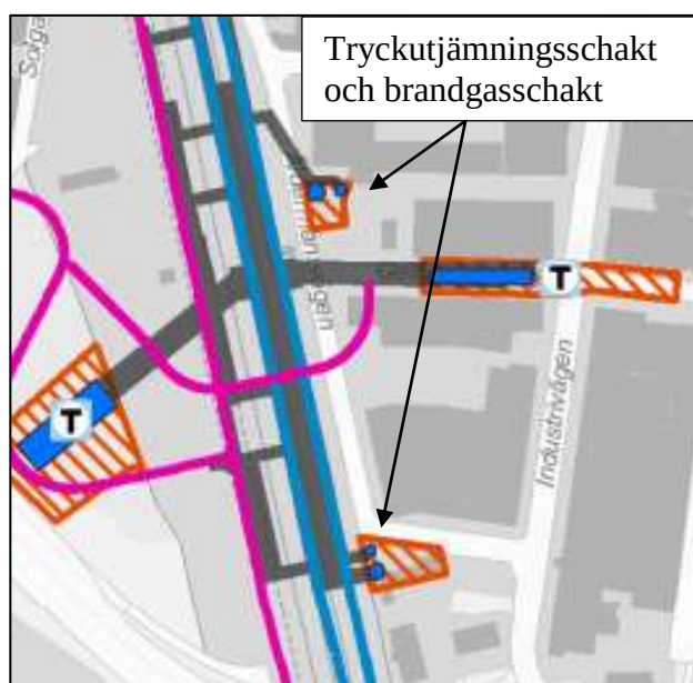
Figur 11 Lägen för tryckutjämningschakt och brandgasschakt
