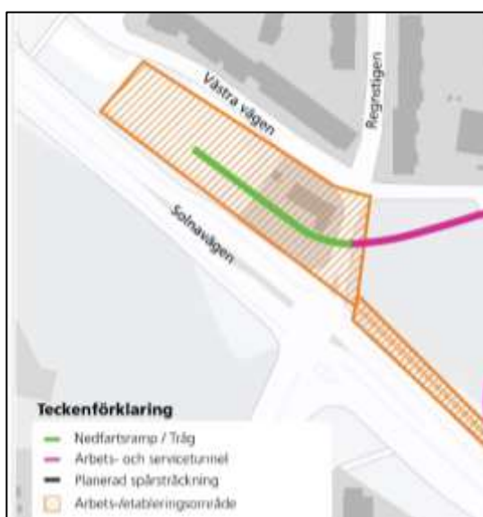
Figur 14: Tråg/ nedfartsramp i grönt samt arbetstunnel
