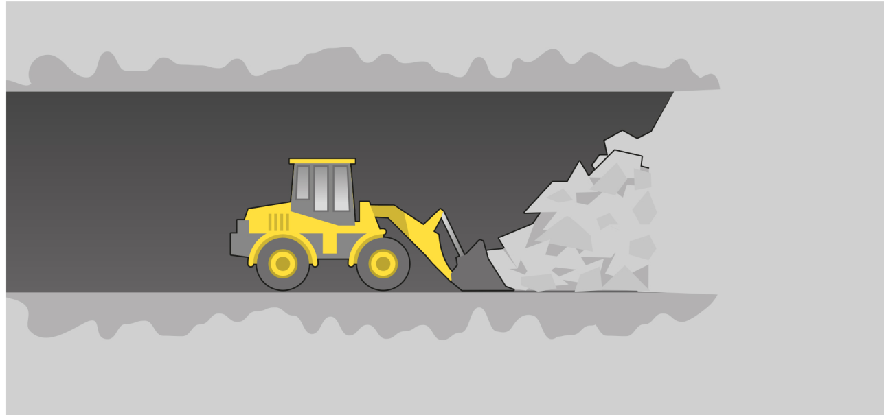
Massorna efter det sprängda berget schaktas undan...och transporteras ut ur tunneln. Bergytan förstärks vid behov med sprutbetong och bultar.
