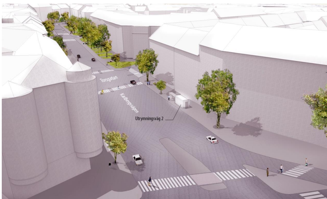
Figur 37. Förslag till placering av byggnad för utrymning nära korsningen Karlbergsvägen/Torsgatan.
