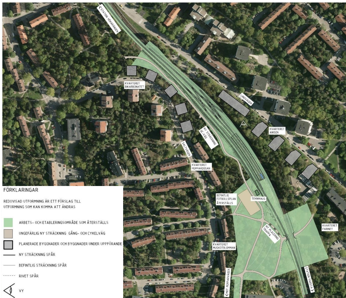
Figur 6. Illustration över den nya anslutningen till Farstagränen. "Vy" avser vypunkt för Figur 7.
