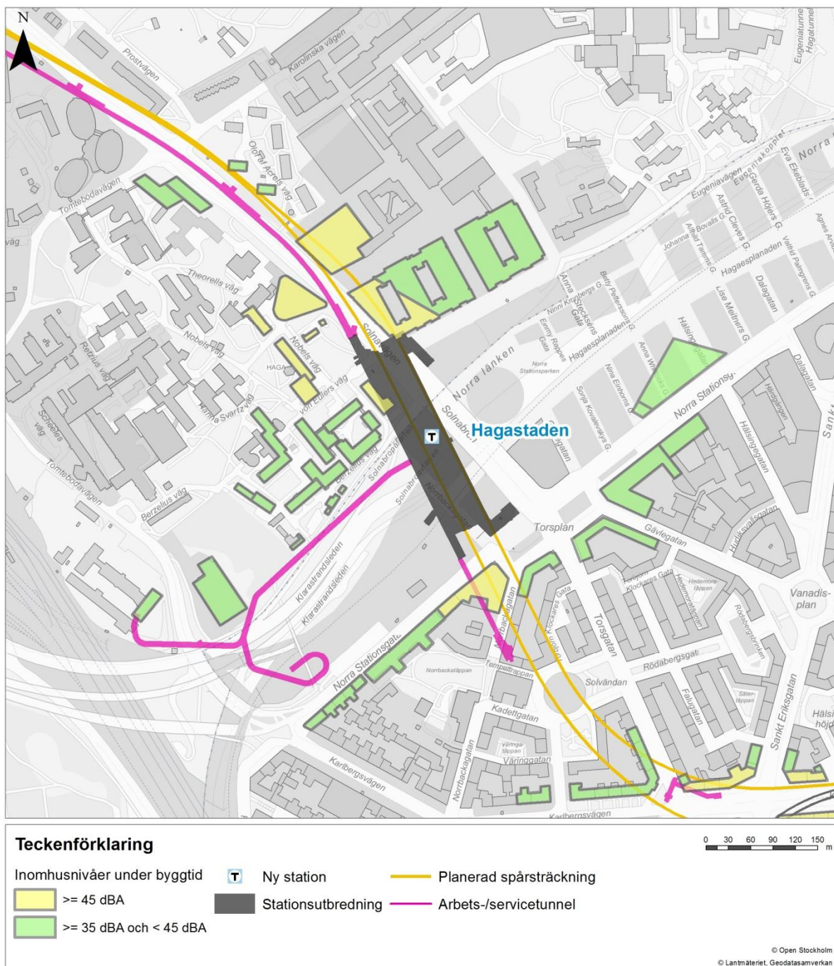
Figur 44. Byggbullernivåer inomhus från ovanmarksarbeten vid byggande av station Hagastaden.
