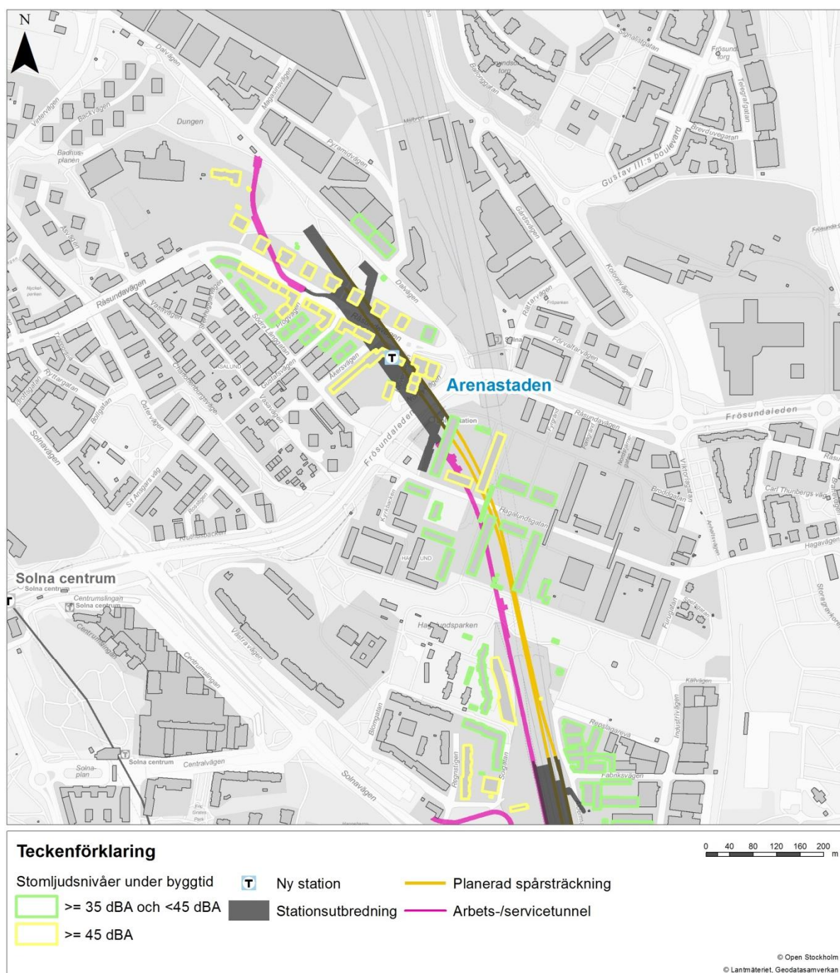
Figur 53. Stomljuds nivåer från tunneldrivning i Hagalund, Råsunda och Arenastaden.
