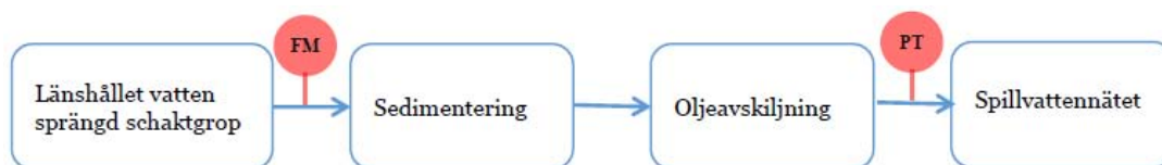
Figur 23. Länshållet vatten från schaktgröp i tunnel, med sprängning.
