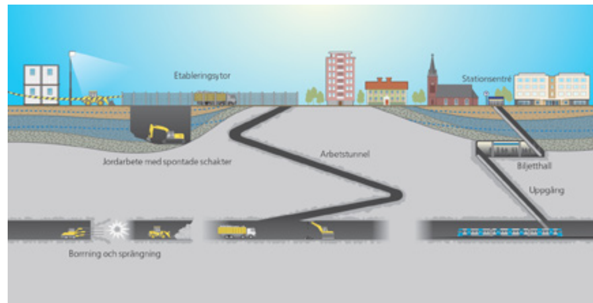
Figur 5.2. Exempel på byggande av tunnelbana samt tunnelbana i drift.
