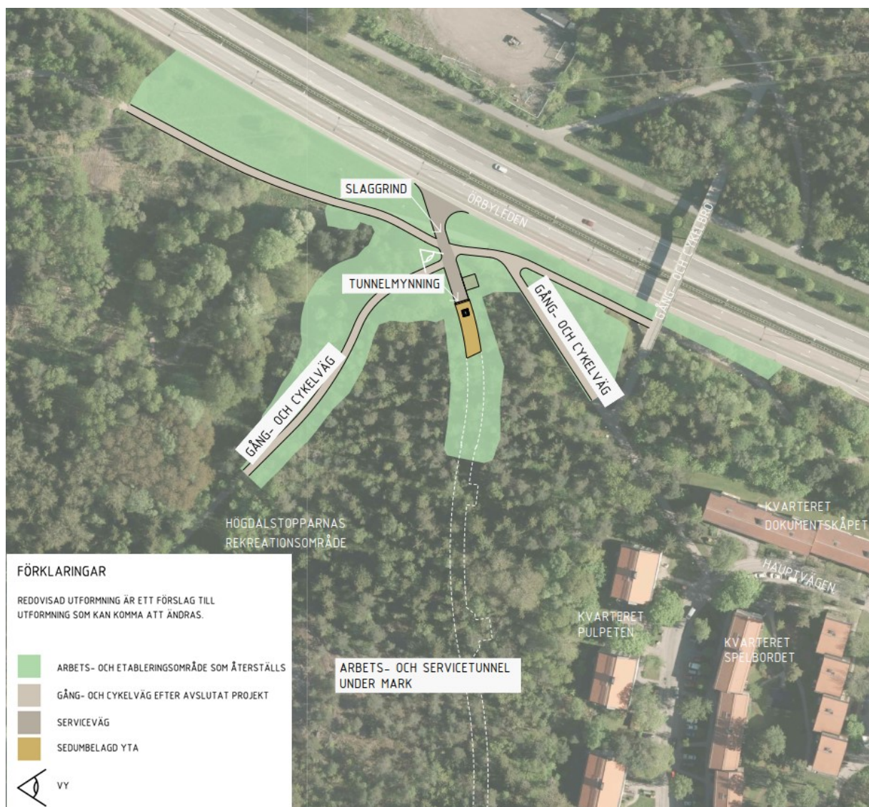
Figur 21. Illustration över arbets-/servicetunnelns norra mynning mot Örbyleden.
