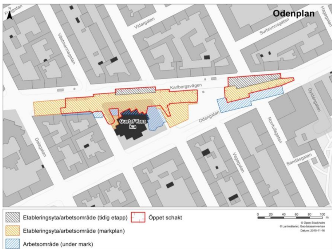
Figur 11. Mark kring station Odenplan som tas i anspråk under byggskedet som arbetsområden och etableringsområden.
