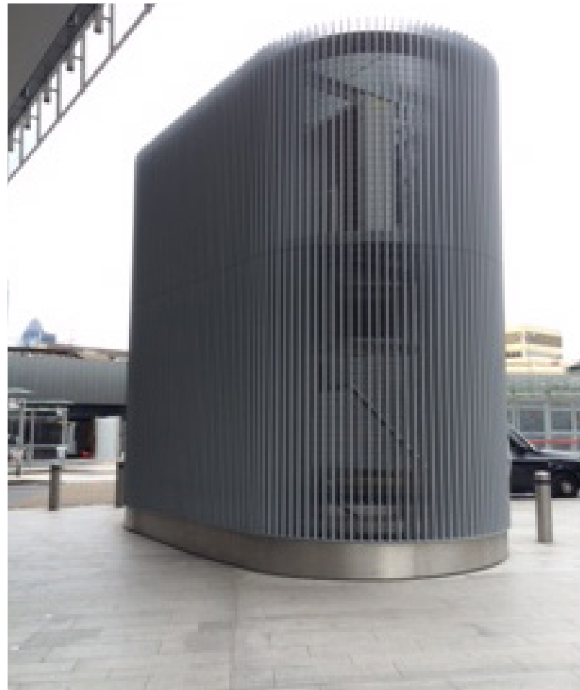
Exempel på väl utformat ventilationschakt ovan mark. London
